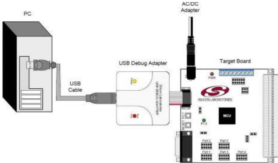
图 1-1 调试器连接示意图
